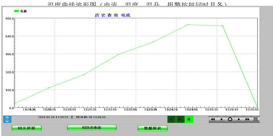
电流曲线波形图 (曲线图上可看到产品电流到达 760A 时的状态)
