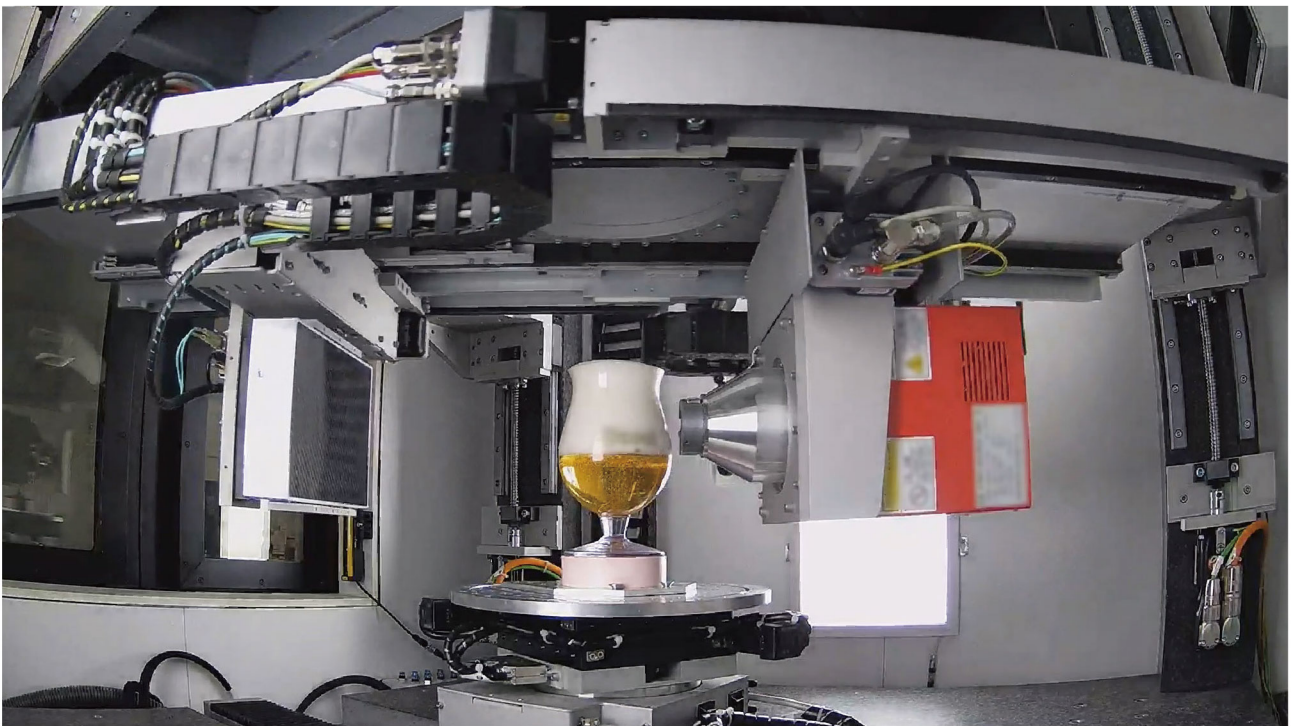
▲ 图 1: 放置在 DynaTOM 内的啤酒泡沫样品。
