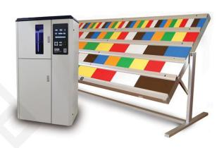
实验室**氙灯老化测试**意义:为了要比自然老化测试更快速地评估材料的抗老化性能,通常我们采用带人工光源的测试设备氙灯老化测试仪来重现和加速老化过程,这样可以不受日常循环和气候条件的影响,并可以得到一个可控的测试环境,从而保证试验过程参数的可重复性和试验结果的可重现性。
