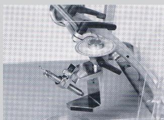
NO.40-角度切磨两轴固定夹具，360度调节定位。
