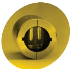
为了简化样品的制备，只须将少至15 $\mu$ L到120 $\mu$ L的样品和参比溶液注入样品池的相对位置，再把样品池放入系统中即可。在一个实验循环中，最多可以同时进行分析，其中每一对组合都可以设置不同的溶质/溶剂条件（pH、离子强度、浓度），这使得在短至3个小时内可以给出进行精确分析所需的数据，你的样品还可以再回收用作其他分析研究。
