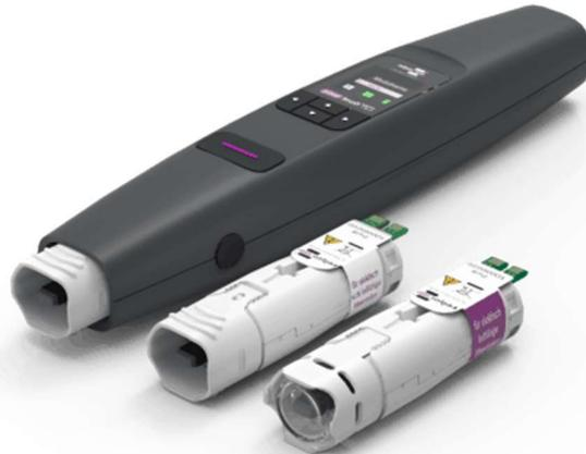
piezobrush® PZ3 是一款小体积紧凑型手持等离子体发生器，适用于实验室开发以及小批量产品的研发和组装加工。piezobrush® PZ3 的最大功耗为 18 瓦，凭借压电直接放电技术（Piezoelectric Direct Discharge Technology – PDD 技术®）可以产生温度低于 50 摄氏度的冷活性等离子体。PZ3 的核心部件是来自 TDK 电子集团的 CeraPlas™，用来产生常压冷活性等离子体的高压放电组件。等离子体能高效加工活化材料表面，同时还可以杀菌消毒和祛除异味。
