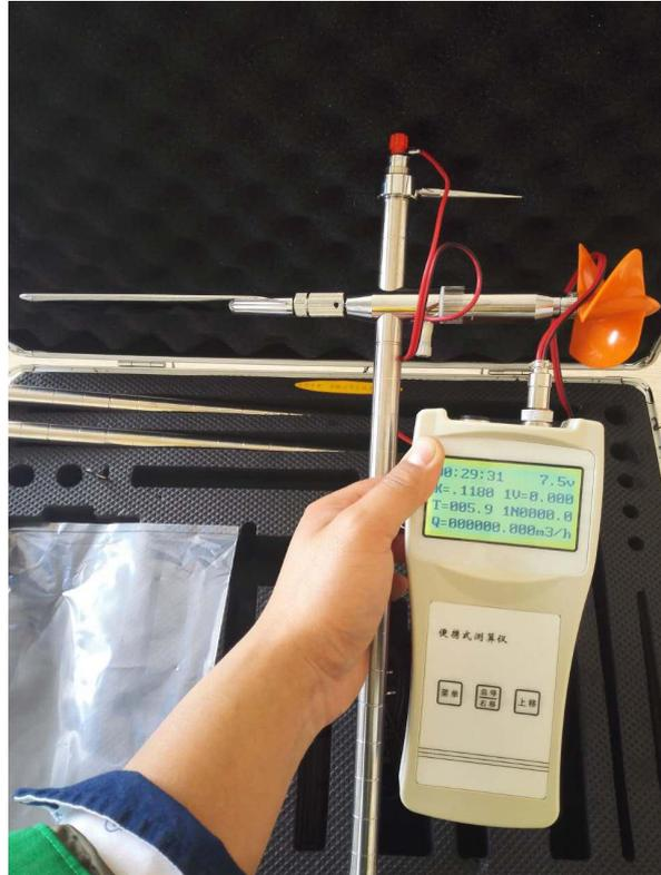
本款仪器是专门为水文站，水文地质调查,环保 监测、灌区等部门而专门研制的新型仪器。该仪器具有耗电省、功能齐全、自动化程度高、稳定可靠,适用性强等优点。适用于接收各种转子流速传感器所产生的信号。
