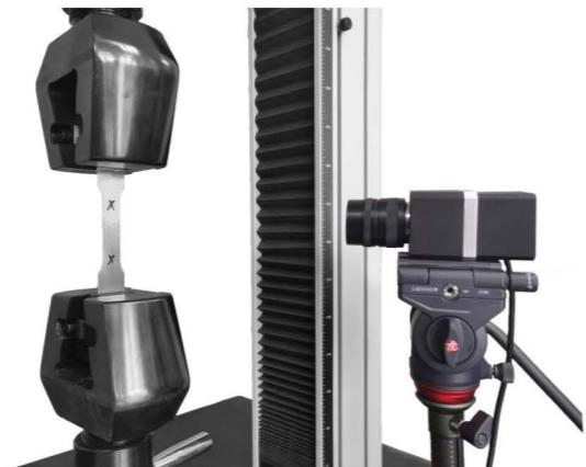
LVE视频引伸计有完善的应变、位移测量功能，支持实时计算显示，支持横纵双向应变同步测量，支持泊松比、弹性模量的计算，同时可输出标准报告，可与实验设备进行数据实时通讯。产品主要功能列表如下：
