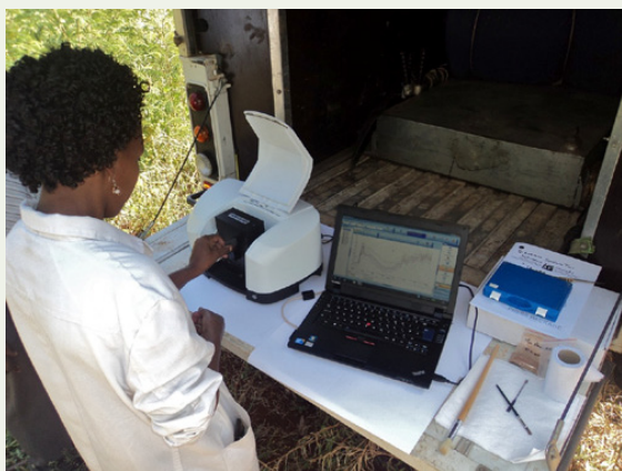
车载带有漫反射附件的Spectrum Two傅里叶红外光谱仪用于测定肯尼亚西部的田间土壤
