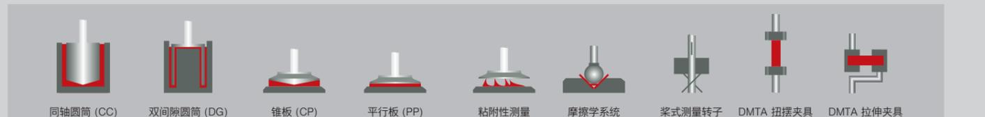
同轴圆筒 (CC) 双间隙圆筒 (DG) 锥板 (CP) 平行板 (PP) 粘性测量 摩擦学系统 桨式测量转子 DMTA 扭摆夹具 DMTA 拉伸夹具
