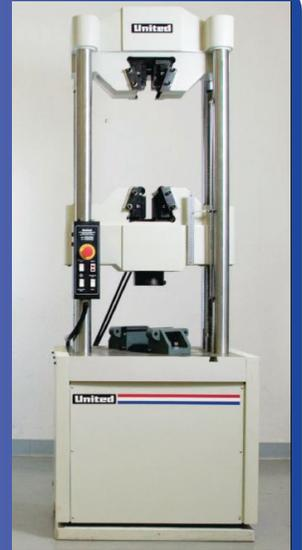
万能试验机支持USB接口用于高速数据传输, 并配备了基于Windows操作系统的操作友好的Datum 5i 测试软件, 同时符合ASTM、ISO、EN、JIS、DIN&BS等多种国际标准的要求。
