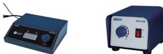
加热罩控制器C-01温度探头
