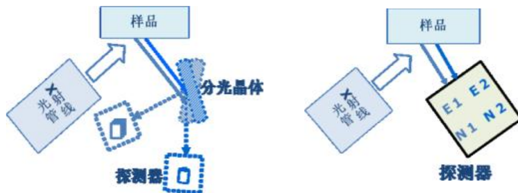
图 5-1 波长色散型与能量色散型 X 射线荧光光谱仪的工作原理示意图
