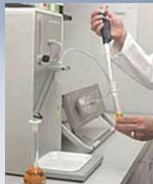
图1 在反应管中加入样品，再加0.5ml溶剂
