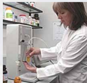
图3 用反应单元的固定支架固定反应管
