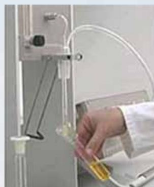
图2 将反应管放在反应单元中的鼓泡口
