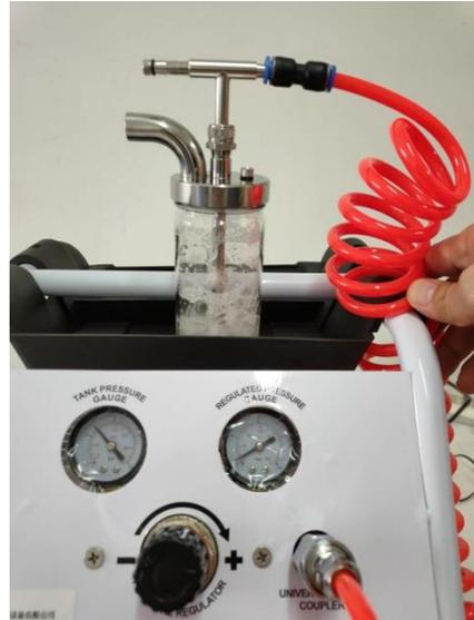
NSF Collison 喷雾器是 BGI 公司为满足美国全国卫生基金会（National Sanitation Foundation, NSF）的要求、在 MRE 型基础上特别设计的短款。NSF 进行生物危害测试时，安全柜内有限的空间需要更短的配置。该款产品型号是 CN311，已广泛用于孢子测试，配有六个喷嘴头，黄铜镀镍加工。它是 NSF 自用并推荐的测试生物安全柜人员安全性和受试样品安全性的喷雾器。
