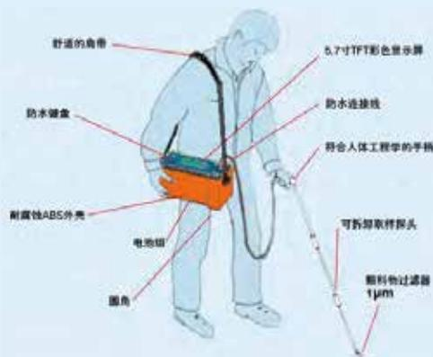
舒适的肩带使测量现场工作人员不疲劳。该探头便于测量汞的表面分布。该探头具有人体工程学手柄，易于拆卸。它可以装在一个单独的袋子里。
