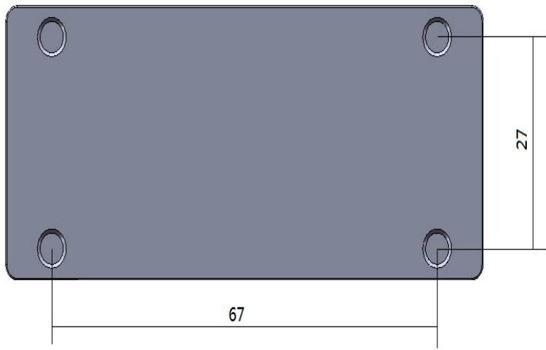
注释：流量计安装孔为M4螺孔
