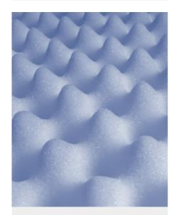
聚合物和泡沫材料 气体膨胀法 广泛用于表征聚合物材料中晶相 和非晶相的相对数量。这项技术 还用于测定泡沫材料的开孔率, 以评估材料在绝缘、隔音或防撞 方面的性能。
