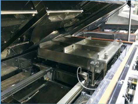
Pyramax Vacuum真空回流焊炉设计用于大尺寸设计考虑了大型EMS/大批量汽车客户的要求。该装置配置了10个闭环对流加热区域，在真空操作条件下，最大生产宽度为457 × 457mm (18 × 18英寸)。在氮气环境下，Pyramax Vacuum真空回流焊炉提供了最高350°C的工艺温度。该装置集成了BTU专有的基于Windows的Wincon™控制系统，并与工厂MES/Industry 4.0完全集成，包括真空参数。现有Pyramax客户可以很容易地把他们的工艺转移到新的Pyramax Vacuum真空回流焊炉。
