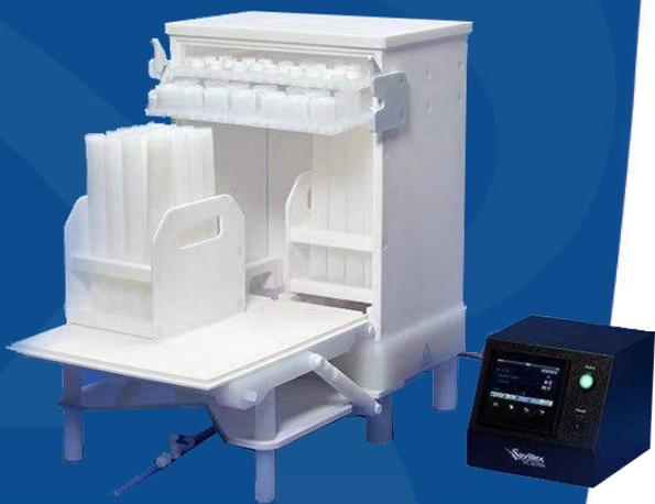
VC Ultra通过对痕量金属级别的酸液进行亚沸蒸馏获得高纯酸蒸汽，从而清洁微波消解管及其他各种实验室器皿。清洁用酸可重复使用，最大程度减少浪费，降低成本。VC Ultra的清洗室可容纳1个或2个清洁支架该清洗支架由PTFE制成。多款不同型号清洁支架可清洁市面大部份消解管。清洗支架固定在清洗室内的卡槽中，并配备拉杆使清洗支架方便安全地滑入和滑出清洗室。清洗室内置两个可移动PFA搁板，用于在清洁消解管的同时清洁瓶盖和衬垫等配件。VC Ultra配置通用清洁套件后可清洗其他各种实验室器皿。该套件包含12英寸PVDF清洗柱、PFA网格板、网格连接件，将清洗柱通过网格连接件固定到网格板，将安装好清洗柱的网格板安装到清洗室内即可使用。清洗柱可轻易切割成任意长度，以适应不同尺寸的实验室器皿，使用多个清洗柱可以支撑更大的器皿。
