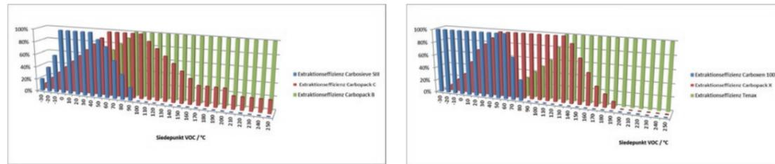
注意：萃取效率不仅取决于沸点，化合物的极性和目标分子的结构也会影响萃取效率。到目前为止，特定的目标物提取需要选择特定的聚合物吸附剂，如对醇类、有机溶剂、脂肪酸和胺类物质的高选择性提取。
