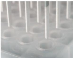
将1ml 液体样品 (例如血液, 尿液, 含水样品) 放入96深孔板中。把深孔板转移到振荡位上, 将 CBD 浸入其样品中, 打开振荡器, 可设定时间 (通常为30 至45 分钟)。由于薄片表面积大, 一方面可以获得高萃取效率 (取决于应用和所选择的涂层, 可高达约100%); 另一方面, 薄涂层也可使萃取速率较快 (包括后面的解吸阶段)。
