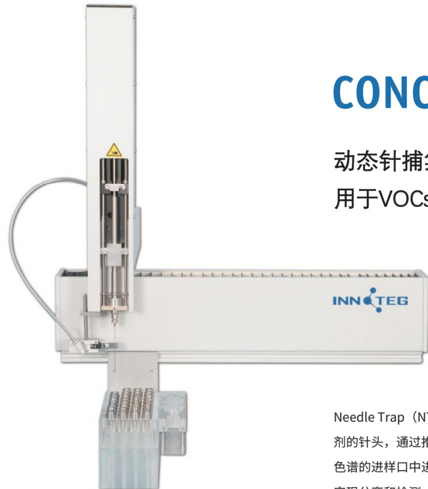
Needle Trap (NT) 动态针捕集装置是一种装有各种吸附剂的针头，通过推拉吸附待测物。吸附好的动态针在气相色谱的进样口中进行热解吸，随后待测物进入气相色谱中实现分离和检测。
