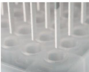
将1ml 液体样品 (例如血液, 尿液, 含水样品) 放入96深孔板中。把深孔板转移到振荡位上, 将 CBD 浸入其样品中, 打开振荡器, 可设定时间 (通常为30 至45 分钟)。由于薄片表面积大, 一方面可以获得高萃取效率 (取决于应用和所选择的涂层, 可高达约100%); 另一方面, 薄涂层也可使萃取速率较快 (包括后面的解吸阶段)。
