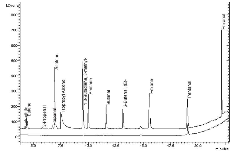
在进样口解析30s后动态针捕集装置的Luer lock 末端用特氟龙帽密封，储存30min 后将该针捕集装置再次插入进样口内进行二次热解吸时，残留量≤1%。检出限可达ppt-ppb 级别。
