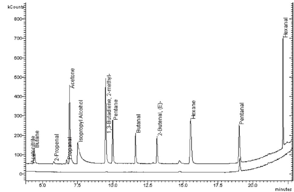
在进样口解析30s后动态针捕集装置的Luer lock 末端用特氟龙帽密封，储存30min 后将该针捕集装置再次插入进样口内进行二次热解吸时，残留量≤1%。检出限可达ppt-ppb 级别。
