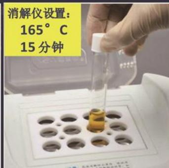
3. 消解管摇匀后放入已预热的消解器消解
