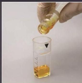
7. 按提示将比色皿中水样换成消解管中溶液
