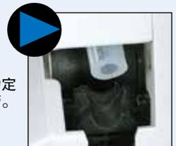
通过泵管自动定位安装泵管。
