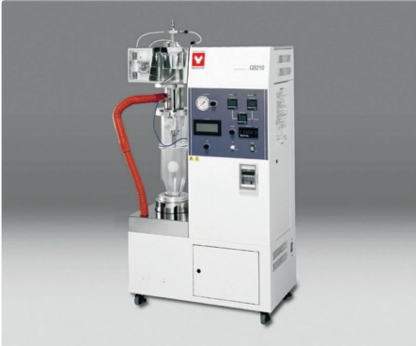
本装置利用流动层进行粉体造粒以及对湿粉体进行干燥。是主机单元GB210与附件GF200组合而成的流动层干燥造粒装置。可应对AC200V、AC220V、AC240V的万能电源。
