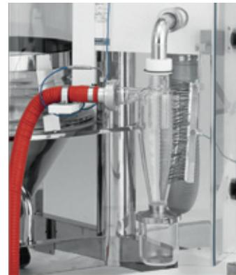
在旋风分离器配置有防止烫伤的安全盖及除静电刷。
