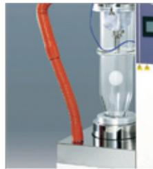
干燥腔、旋风分离器、生成物容器的拆卸或清洗采用的是快插方式，可以很方便的进行。
