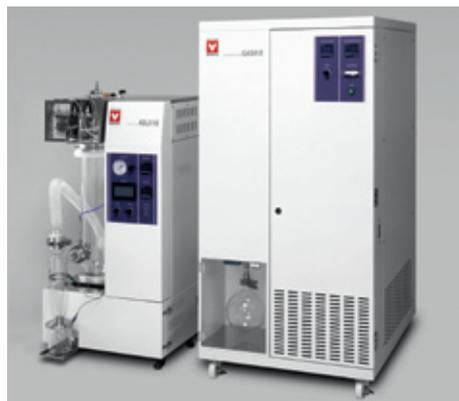
设置例: ADL311S+架台 (选购)+有机溶剂回收装置GAS410
