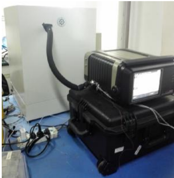
图 19 加热管线及便携式气相色谱-质谱联用仪
