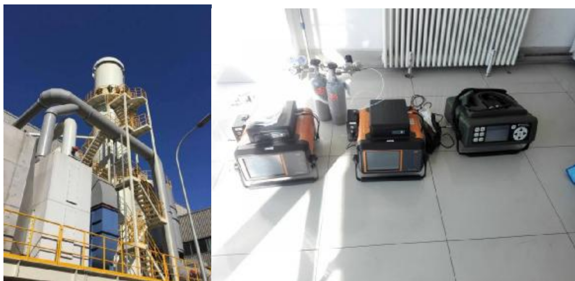
图 1-1 北京某汽车生产企业喷涂车间大气固定污染源现场采样和精密度测试
