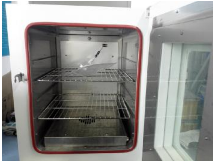
图 18 放置气袋并加热的烘箱
