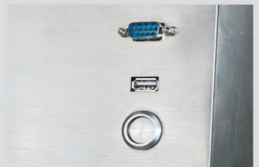
RS-232接口，连接打印机
