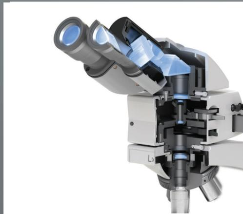
高度流线型外观设计的Lx POL专业偏光显微镜, 人性化的设计及精密的机械制造与设计, 给使用者提供可靠而且舒适的观察应用体验。可转换的伯特兰透镜系统 (Bertrand Lens), 无应力的专业偏光物镜SF系列, 偏光聚光镜, 对中型偏光物镜转盘, 360度旋转对圆形载物台, 配套使用的起偏-检偏系统, 乃至高度精密的多种偏光波长补偿器组合, 为整套系统显现出色的偏光观察效果 (良好的对比度及清晰度) 及精密测定样品的光学特征参数 (如轴性、光性正负、光轴角) 等专业偏光应用提供了可靠的保证。
