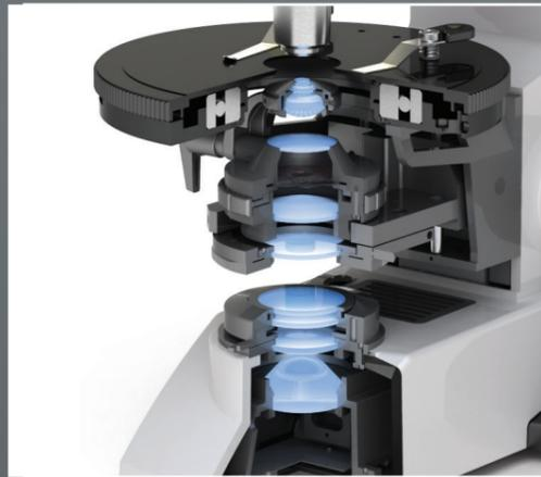
当使用者需要进行精确的锥光镜检偏光观察时, Lx POL内置的可对中调焦伯特兰透镜系统可将平行偏光束变为锥形偏光束而照射到标本。在一套偏光显微镜系统中集成有正交镜检及锥光镜检两种功能, 为不同应用的使用者提供了极大的便利。同时, Lx POL不但提供透射光专业偏光系统, 也提供透射光-反射光 (落射光) 专业偏光系统。
