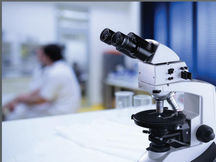
Lx POL专业偏光显微镜系统标准配置有三种偏光波长补偿器分别为全波长 ( $\lambda$ , 定义样品的光学正负符号补偿器) 补偿器,  $1/4$  波长 ( $1/4 \lambda$ , 直偏光转圆偏光互换器及塞拿蒙测量辅助) 补偿器, 以及石英楔 (Quartz Wedge, 半定量补偿器) 补偿器。
