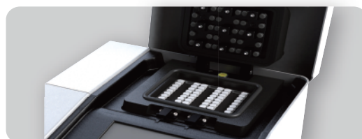
兼容Opal高通量芯片和Sapphire高灵敏芯片 可同时进行1–48个样品的微滴生成和检测
