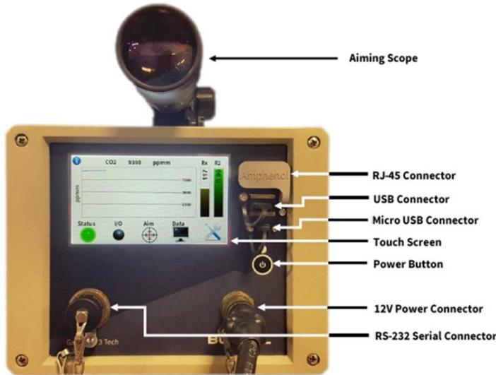
便携式激光气体探测器用于开放路径环境和安全监测，GasFinder3 技术平台处于 Boreal 的下一代行业领先。凭借全新的数字电子产品和重新设计的光学平台，GasFinder3 技术为性能、灵活性和易用性设立了一个新标准。
