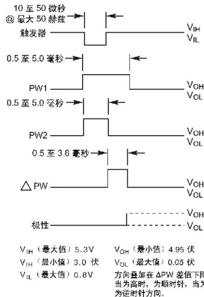
电压输出兼容 TTL, 每种输出可驱动一个低功耗肖特管或多个 CMOS 设备。
