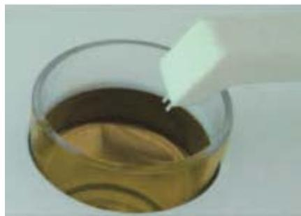
5 自动加入50ml水、邻菲罗啉指示剂，硫酸亚铁标准溶液滴定
