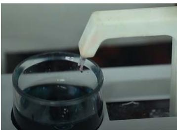
滴定分析是化学实验中常用的分析方法。人工滴定耗时长，操作繁琐，依赖人眼判断滴定颜色突变终点。土壤有机质分析机器人采用光学原理滴定分析——颜色变化自动判断滴定终点。随着科技的发展，光学测量原理在分析仪器发展中得到越来越广泛的应用，可以取代人眼进行滴定终点判断。
