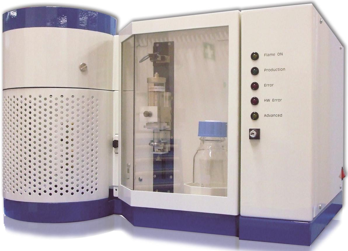
桌面式火焰喷雾热解装置
