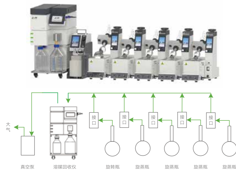
搭载溶媒回收仪系统原理示意图
