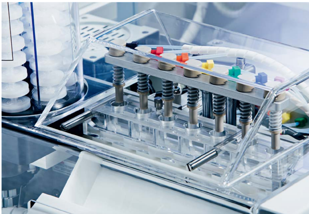
自动交换 25mm 滤膜 SOTAX 建议使用 PALL 全自动认证过滤器 PALL Life Sciences
