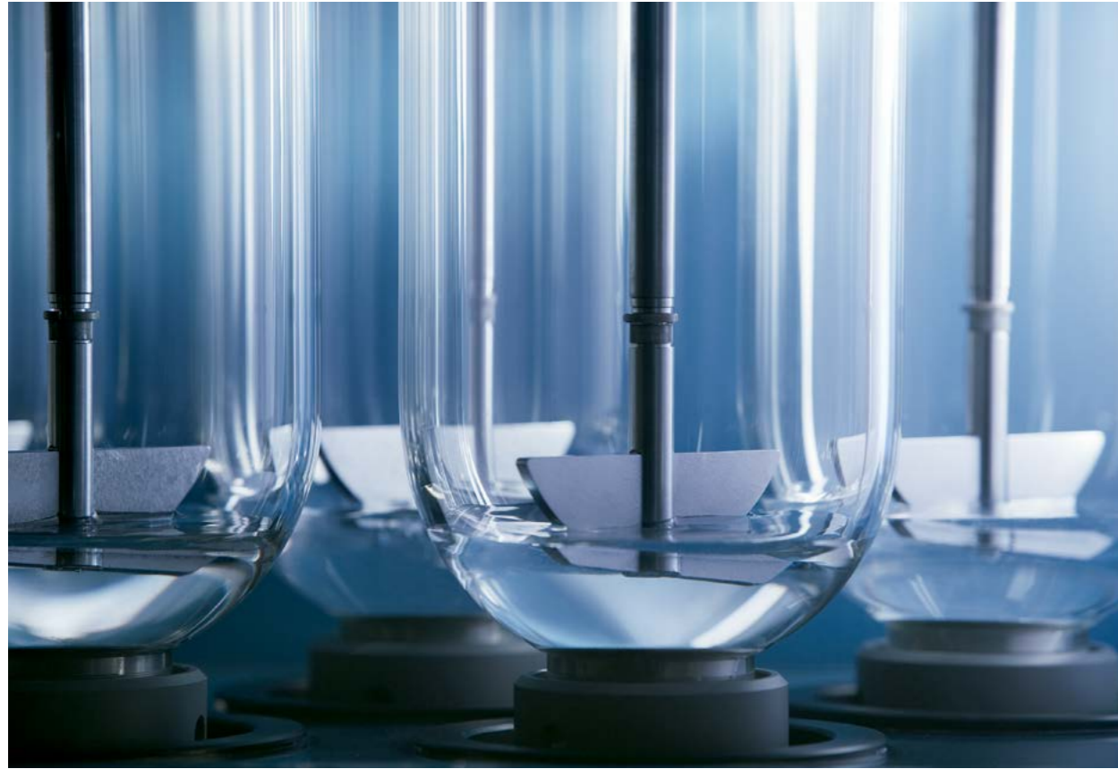
通过半球阀同步将溶媒分配到溶出杯中
