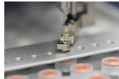
ATS 4 可加热喷嘴，降低大体积及难挥发点样溶剂的影响
