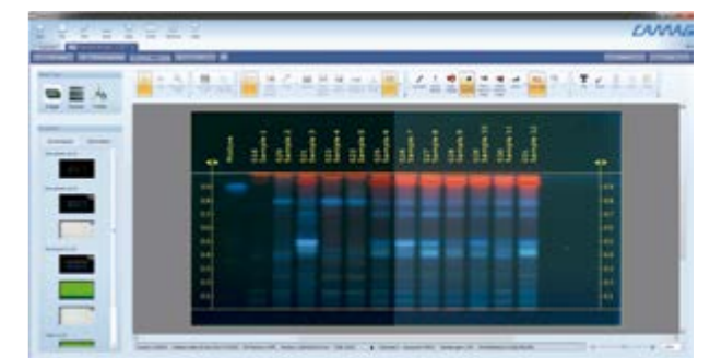
图像增强功能：针对微弱斑点进行曝光优化增强图像效果 (左图为增强前，右图为增强后)。
