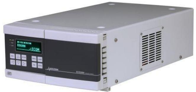
检测器有连续变化的波长，范围分别为 190-600nm, 190-800nm，噪音水平在  $\pm 3 \cdot 10^{-6}$  AU.
