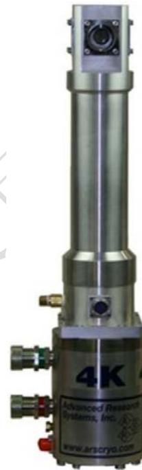
X-1AL 系列标准光学型闭循环低温恒温器因其测试灵活, 价格经济而成为绝大多数实验室样品及装置测试的最优选择, 该系统广泛应用于各种光、电、磁测试。
