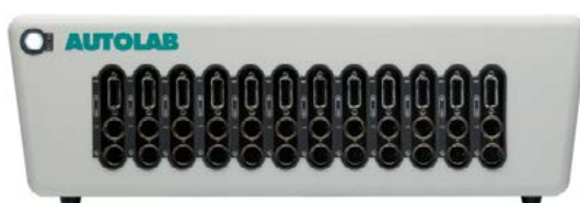
12通道 每个通道只包括一个恒电位仪板卡
