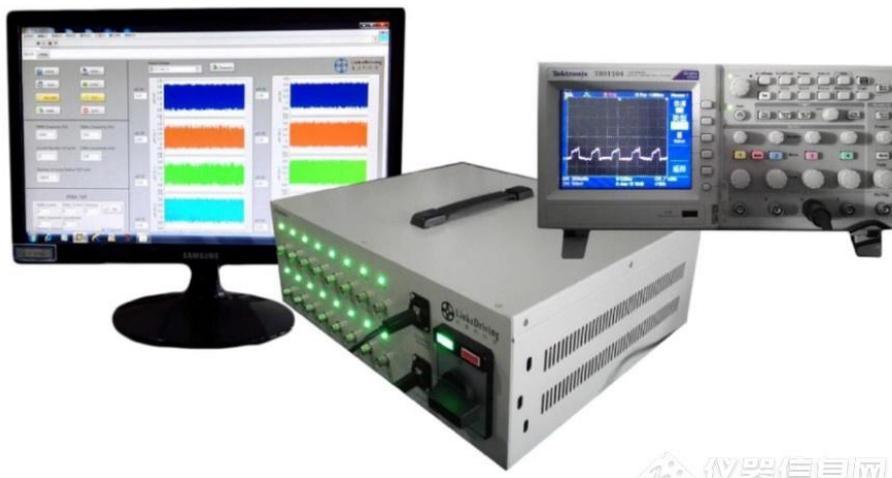
图一：系统硬件组成（不包括电脑和外部示波器）
