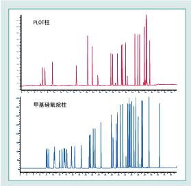
炉温无需降至低于室温即可完全分离,高挥发性组分首先被分流向PLOT柱上,较不易挥发的被分析物则在甲基硅氧烷柱上得到分离。每根柱分别连接到不同的检测器,可同时产生两张色谱图。
