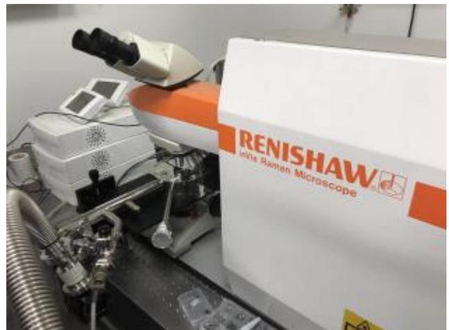
LT3-OM 低温恒温器专为显微拉曼设计，也适用于其它各类低振动要求的光学显微实验。1.52 英寸的样品腔设计使得该恒温器可用于大多数显微测试台。它有连续可调的样品座，利于用户更好调节工作距离。
