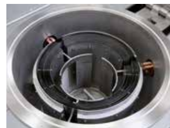
带钨丝加热装置的圆柱形气密罐
