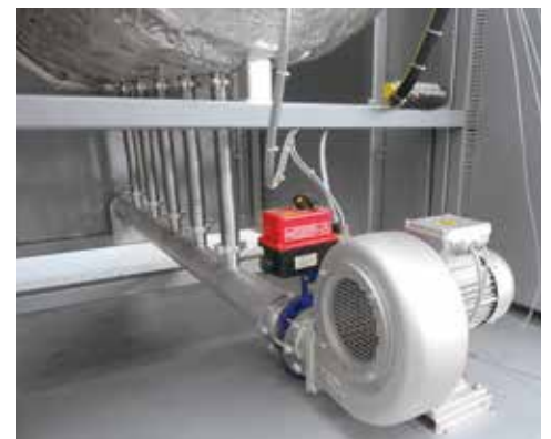
NRA 400/03型热壁罐式炉的鼓风机冷却
