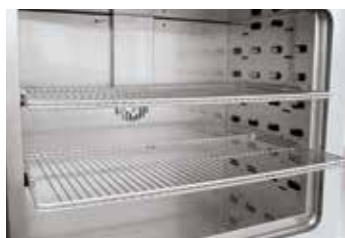
可拔出的格形栅板，用于在不同的装载层对干燥箱进行装载
