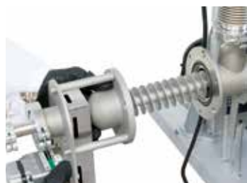
转速可调节式螺旋输送机
