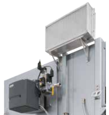
直接气体加热的箱式干燥炉
