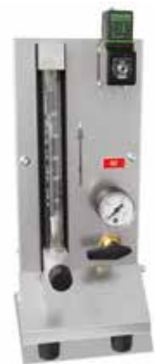
气体供应系统，用于不可燃的保护气体或反应气体，带有截止阀和带调节阀的流量计，可选配电磁阀
