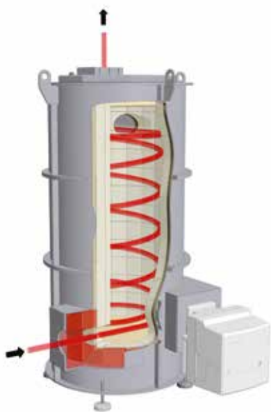
热力式后燃烧器 (TNV) 示意图
