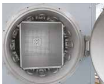
NRA .. /06型罐式炉的内置加热装置
