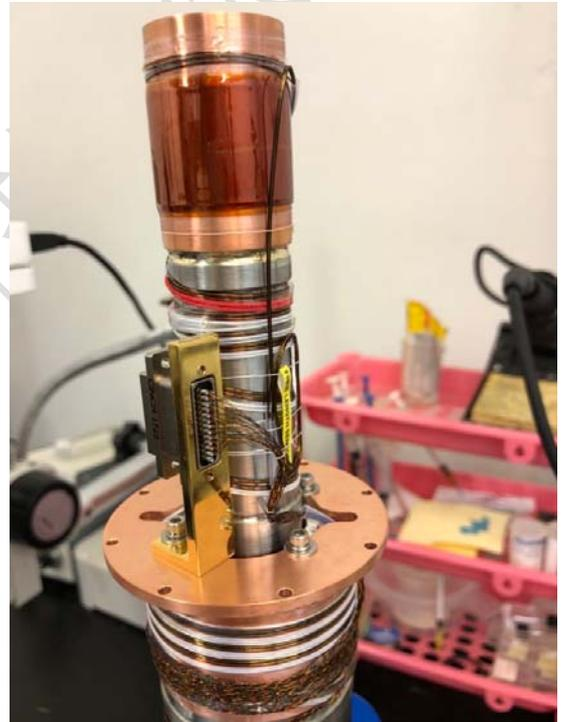
X-4 大样品腔闭循环恒温器拥有不锈钢结构和仪表群, 并有更大的样品空间, 可放置金刚石压砧或其他大体积样品。标准的真空罩有 4 个窗口位置, 底部可加第五个窗口位置。
