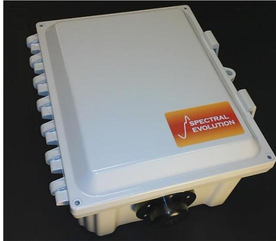
UDS-1100是美国SEI专为野外连续监测开发的双通道光谱仪，可同时测量上行辐射和下行辐射，并排显示辐射亮度和辐射照度光谱。UDS-1100有两种配置：一种是标准配置，用于野外现场测量；一种是UDS-1100SA独立配置，可用于野外无人值守长时间测量。两种配置均内置于NEMA4防护机箱里，防雨防尘。
