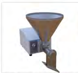
螺旋进料器，适合小尺寸样品或颗粒状样品的连续进样。
