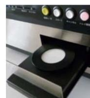
STEP 1 放入基准样品槽校准
