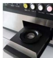
STEP 2 放入透射样品槽测试
