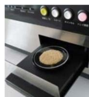
STEP 2 放入反射样品槽测试
