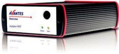
AvaSpec-Fast 系列光谱仪是 AvaSpec-2048 光谱仪的衍生产品，为了使光谱获取或积分时间优化而设计的。得益于光谱仪的硬件板卡存储功能 -Store to RAM，AvaSpec-Fast 系列光谱仪最多可以实时存储 5637 幅光谱。
