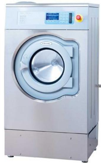
设有自动洗涤剂分配器，可进行多次连续水洗、脱水而无需间断。也可提供补重织物、稳定性模板及测量标尺、标准洗涤剂、漂白剂，护理剂等，详见以下规格。
