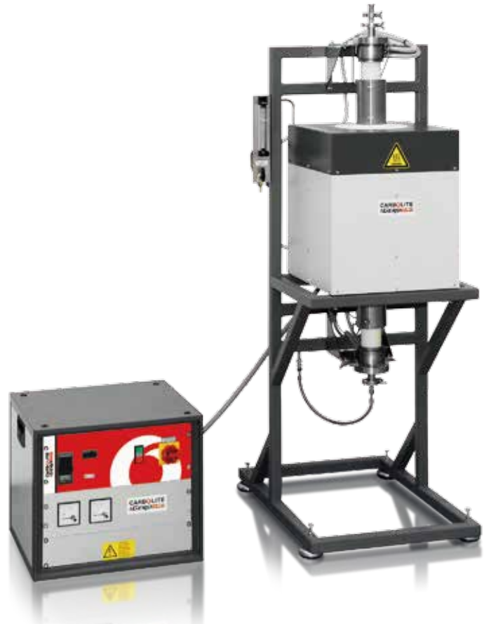
HTRV 18/70/250，配有3508P1控制器，L型支架，电流电压表以及用于高真空 / 惰性气氛环境的组件（高真空环境时最高温度1450 °C）。机械泵和涡轮分子泵为可选项。
