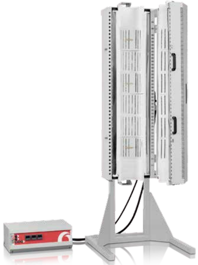
KVZ 12/200/1200 配3216P1主控制器和两个3216CC子控制器
