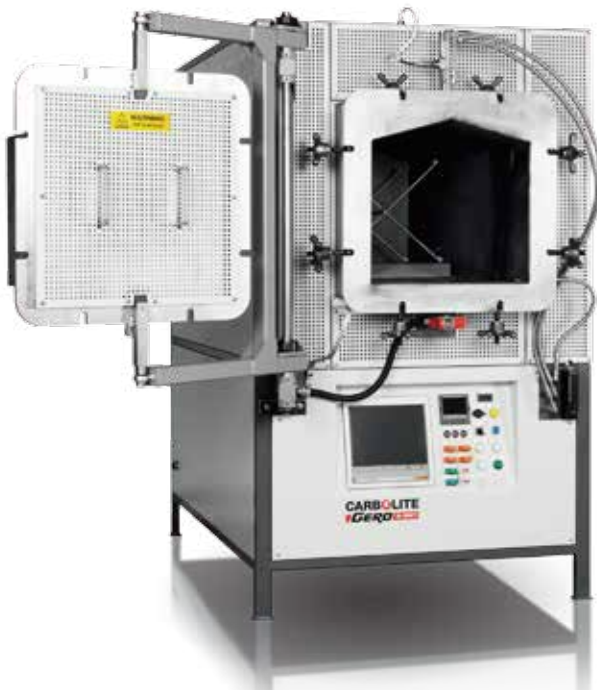
用户定制的GPC 13/300B，配反应罐，符合AMS 2750E Class 1、A类仪表配置。用于排胶和烧结工艺 ( Ref. no. 735056 )
