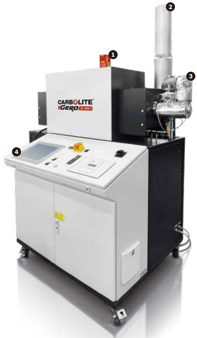
HTRH 16/100/600: 氢气气氛管式炉加热长度600mm，最高工作温度1600°C，纯氢气氛操作，配备全套安全装置。
