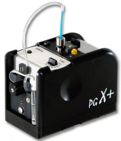
内置集成泵能提供低至 0.5 微升的液滴，内置摄像头捕获单液滴图像从而确定静态接触角或以时间变化来测试液滴的动态润湿、吸附速率和扩散速率。PGX + 软件可以测试液体的表面张力，计算固体的表面能等，PGX + 能直接连接到 USB 端口的笔记本电脑或台式电脑，然后生成报表保存数据。
